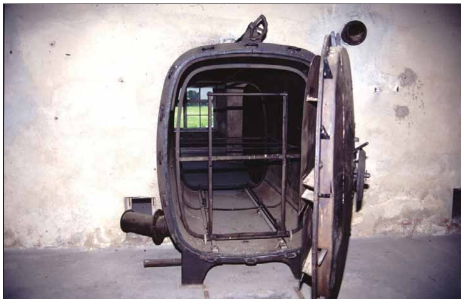
Abbildung 36: Autoklav für Dampfdesinfektion in der sogenannten "Zentralsauna" in Auschwitz-Birkenau (Leuchter et al. 2014, S. 272).
