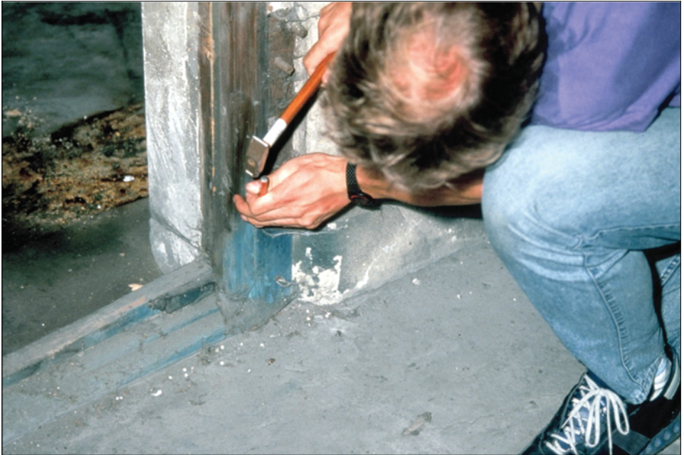
Abbildung 145: Aufnahme des Türpfostens aus dem Entwesungstrakt des Bauwerks 5a (zwischen Raum 2 und Raum 1 in Abbildung 41) mit dem Autor. Das untere, rostige Scharnier hat mit Blausäure Eisenblau gebildet. Entnahmestelle der Probe Nr. 18.
